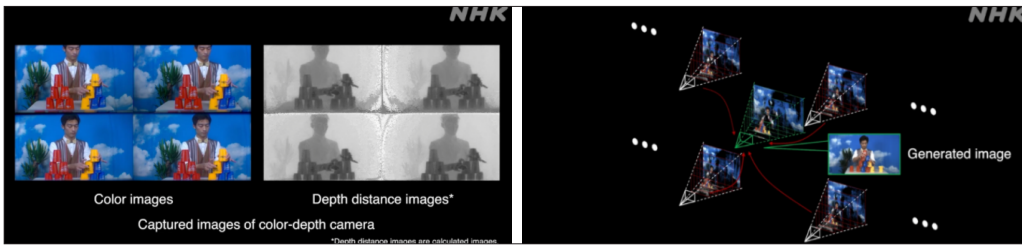
<그림 9> 24개의 컬러 카메라와 깊이 정보 카메라를 통한 중간 시점 생성 과정
