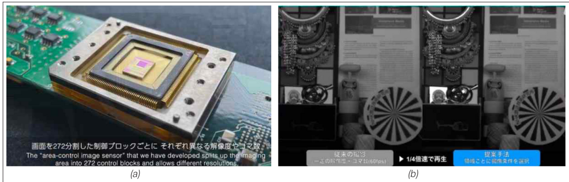
<그림 1-12> (a) NHK STRL에서 개발한 장면 적응형 이미지 센서. (b) 기존 센서로 획득한 영상과 적응형 센서로 획득한 영상과의 비교로서, 우측의 적응형 센서로 획득한 영상에서 어두운 부분이 더 잘 보이며 움직임이 있는 바퀴의 선들이 더 선명하게 보임을 알 수 있음. (출처: NHK STRL Open House 2023)
