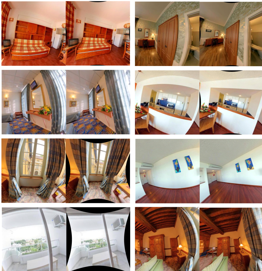
그림 8. 예측한 카메라 파라미터를 이용한 왜곡 보정 결과. 좌: 원본영상, 우: 왜곡 보정된 영상 Fig. 8. Undistortion results using predicted camera parameters. Left: Original image, Right: Undistorted image
