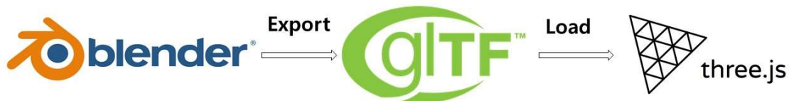
그림 2. Blender를 통한 디지털 트윈 표현 아키텍처 Fig. 2. Digital twin expression architecture with Blender
