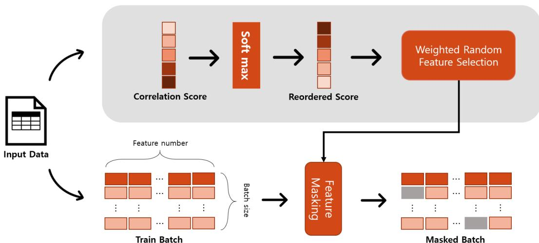
그림 2. 네트워크 품질 예측을 위한 상관관계 기반 정형 데이터 증강 기법 개요도
