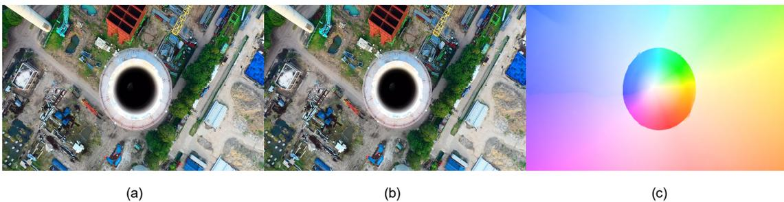
그림 3. 드론의 고도 상승 시 광학 흐름 (a) 13<sup>th</sup> 프레임 (b) 14<sup>th</sup> 프레임 (c) 수렴하는 형태의 광학 흐름
