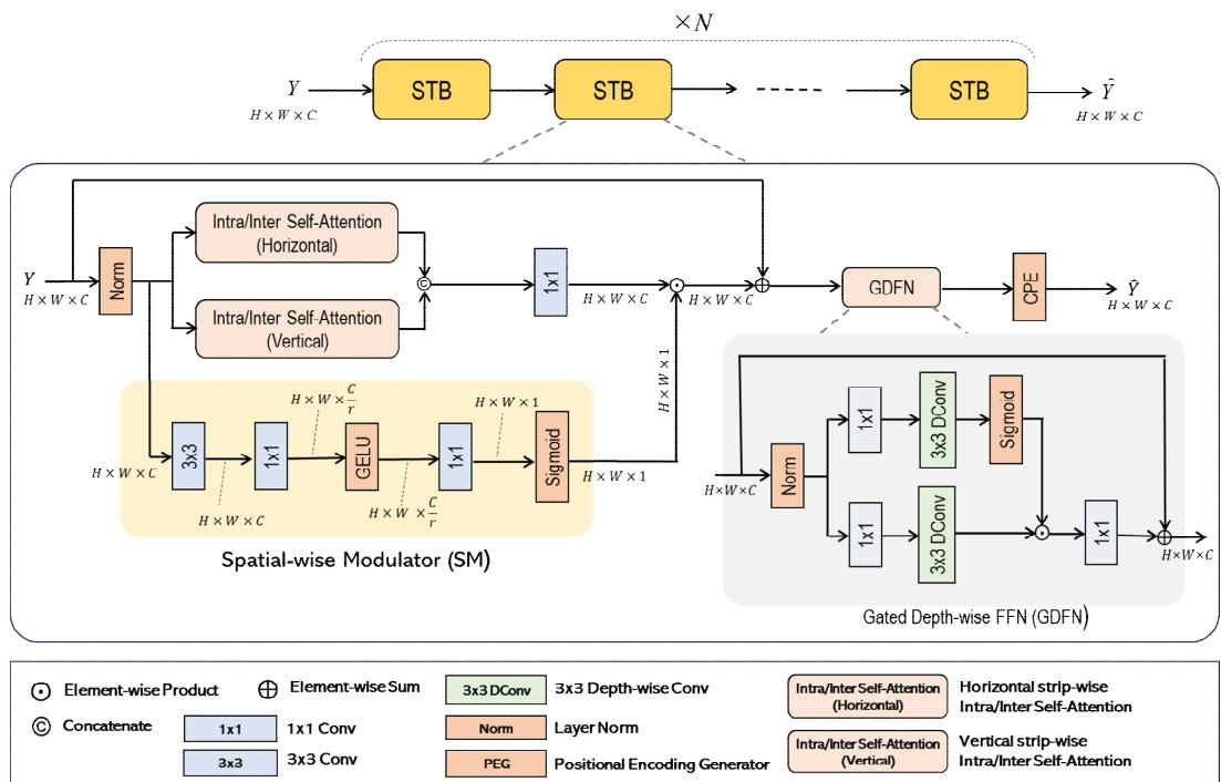
그림 3. GUN 디코더의 구성요소인 Spatial-wise Transformer Block Group (STBG) 구조
