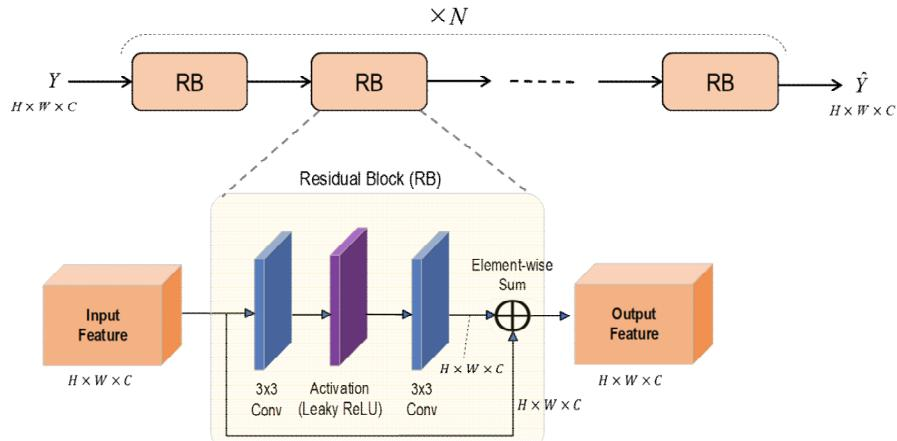
그림 2. GUN 인코더의 구성요소인 Residual Block Group (RBG) 구조
