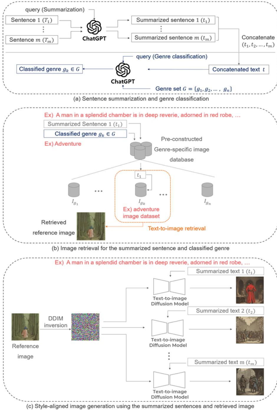
그림 2. 본 논문에서 제안하는 프레임워크. 해당 프레임워크는 크게 세가지 요소로 구분된다: (a) 문장 요약 및 장르 분류, (b) 요약된 문장 및 분류된 장르에 적합한 이미지 검색, (c) 요약된 문장과 검색된 이미지를 사용한 일관된 이미지 생성
