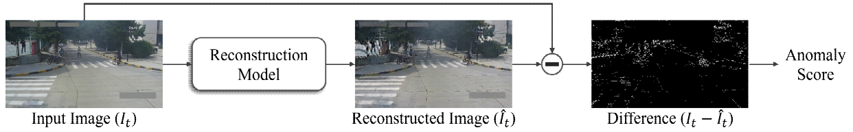
그림 1. 대표적인 준지도학습 복원 기반 이상 감지 프레임워크 Fig. 1. Representative semi-supervised anomaly detection framework using reconstruction
